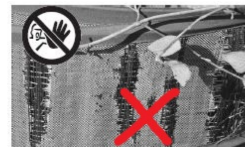
Gebinde mit Rissen und Löchern sind sehr problematisch, da sich Äste und Ähnliches zu oft verfangen und somit schwer zu leeren sind. Die Löcher werden noch grösser.
